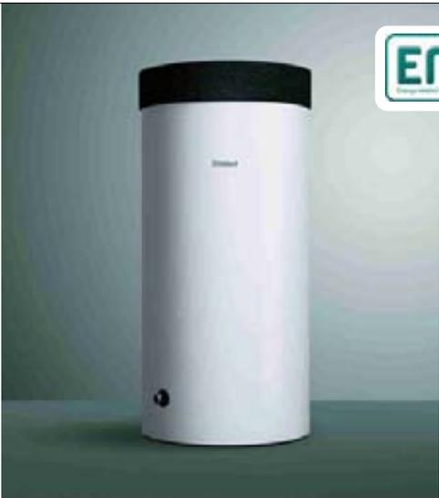
Monovalentes para instalaciones sólo con caldera o bomba de calor. De instalación sobre suelo (excepto VIH R Q 75 B), con cuba de acero vitrificado y 10 bar de presión máxima de servicio, su aislante térmico de EPS es desmontable para permitir su paso a través de cualquier puerta estándar.
