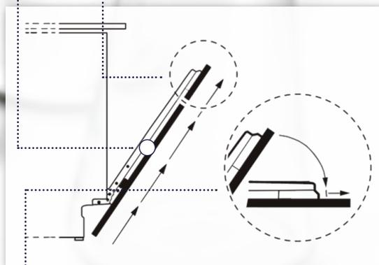
○ Cuando la puerta se abre, el mecanismo deslizante PerfektFit™, integrado de la puerta, la moverá hacia arriba.
