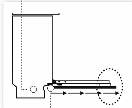
○ La puerta se puede abrir completamente sin rozar con el zócalo.
